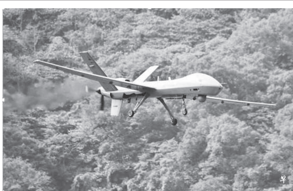
“腾云号”特色是中高度、长滞空；具备自主起降，多机操控，联网导航和即时影像传输功能，可日夜执行情报搜侦，也设计具“侦查及打击一体”功能。
