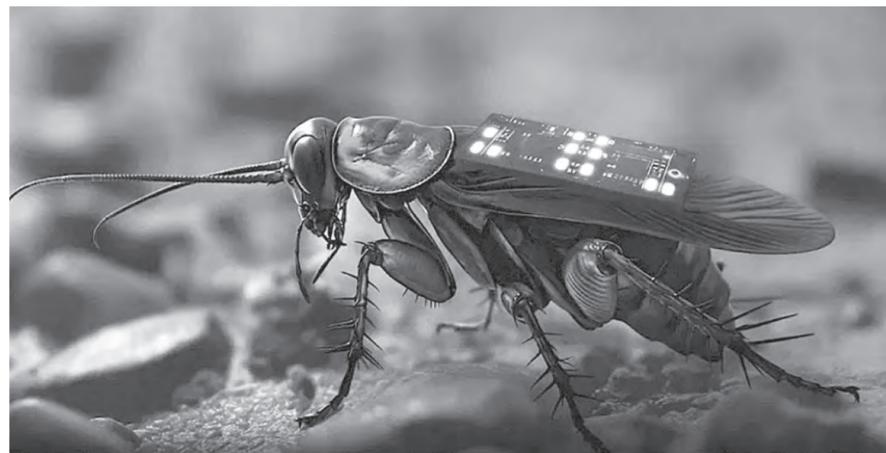
德国新创公司Swarm Biotactics 正研发“生物机械混合体”，在蟑螂背上安装微型控制模组，包括神经刺激电极、传感器及通讯装置，仅以微电流引导其移动方向，配合AI系统即时传输影像与环境数据，改造成可操控的侦查工具。
